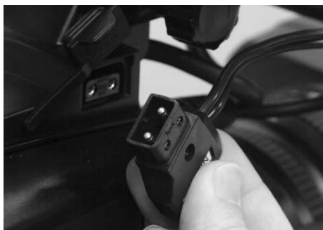
写真2 標準での電源コネクタはカメラ本体から直接受電可能なパワータップ2ピン(オス)
