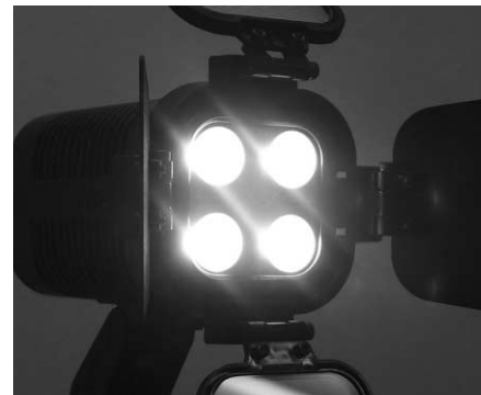
写真4 3Wの高輝度LEDを4つ搭載
